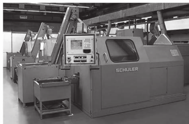
ドイツ・ゲッピンゲンの Schuler 社製コイン用プレス機。硬貨は1分間に1回プレスされ、最大800個の硬貨を製造
