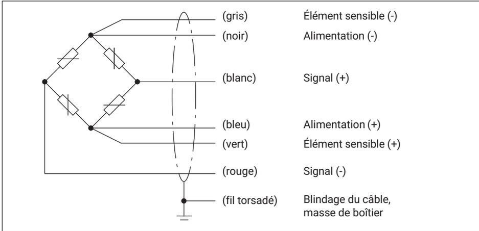
Les champs électriques et magnétiques provoquent souvent le couplage de tensions parasites dans le circuit de mesure. C'est la raison pour laquelle:
