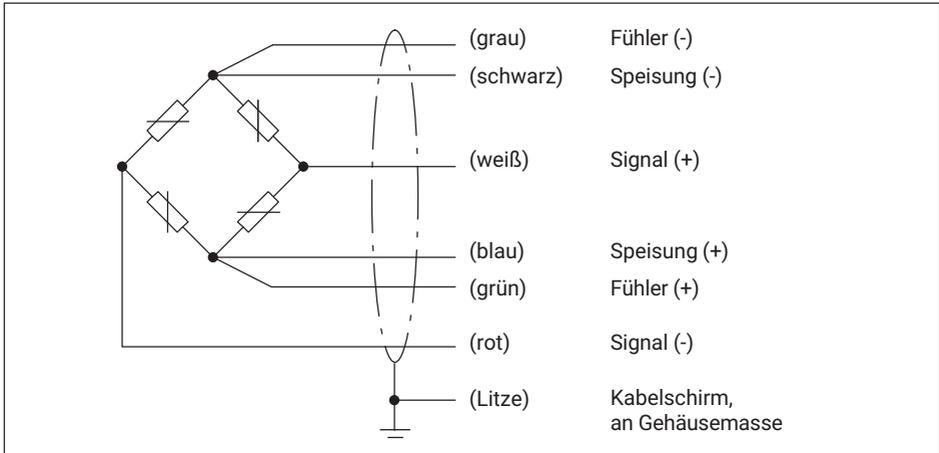
Elektrische und magnetische Felder verursachen oft eine Einkopplung von Störspannungen in den Messkreis. Deshalb:
