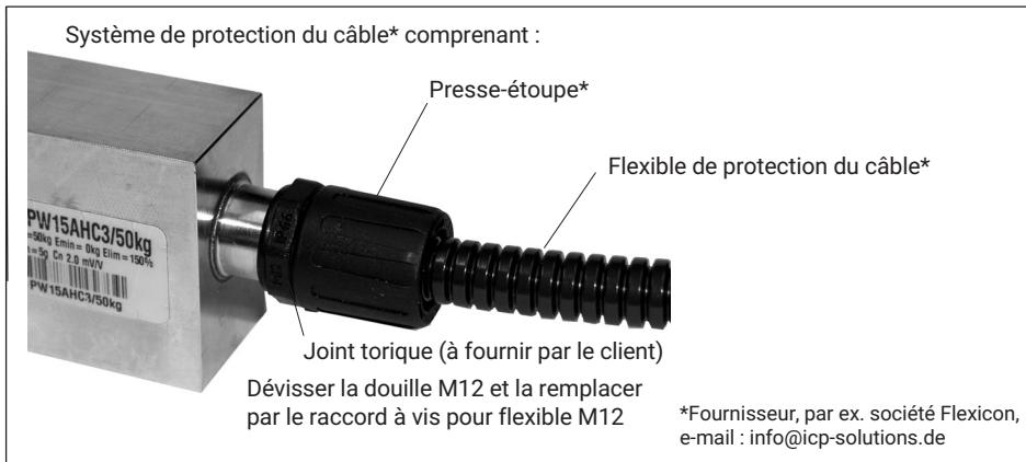
Les pesons standard atteignent le degré de protection IP68/IP69K, même sans système de protection du câble. Dans les applications où le câble PVC du peson risque d'être attaqué ou détruit par voie chimique ou mécanique, il est possible de protéger le câble en supplément avec des systèmes de protection de câble courants.
