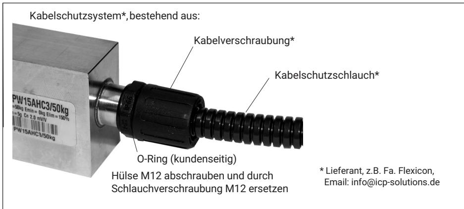
Auch ohne Kabelschutzsystem wird bei den Standardwägezellen die Schutzaart IP68/IP69K erreicht. Bei Anwendungsfällen, bei denen das PVC-Kabel der Wägezelle chemisch oder mechanisch angegriffen oder zerstört werden kann, ist es möglich, das Kabel mittels handelsüblicher Kabelschutzsysteme zusätzlich zu schützen.
