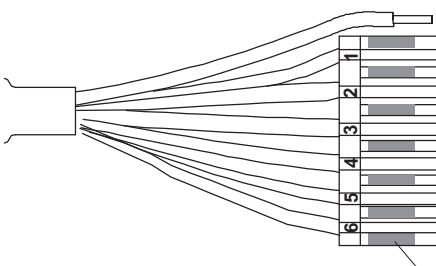
Blindage (ja) = blindage de câble relié au corps du capteur de pesage
