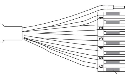
Schirm (gelb) = Kabelschirm mit Wägezellenkörper verbunden
