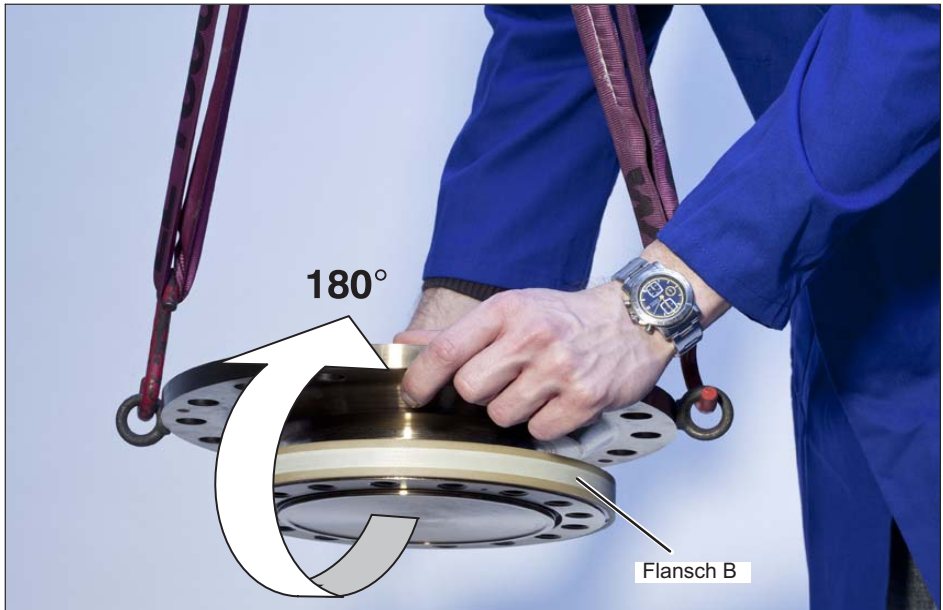
Abb. 5.2 Drehen des Rotors
