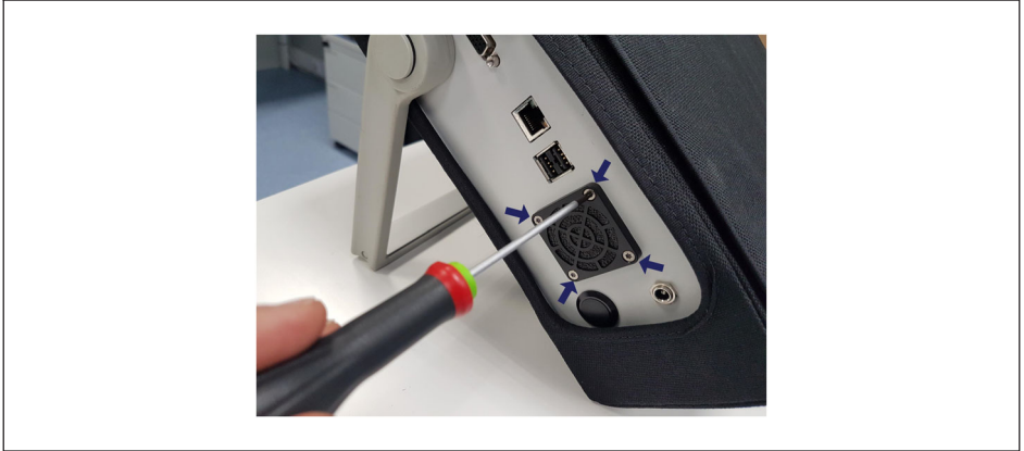
Fig. 3.15 Fan filter fixation
