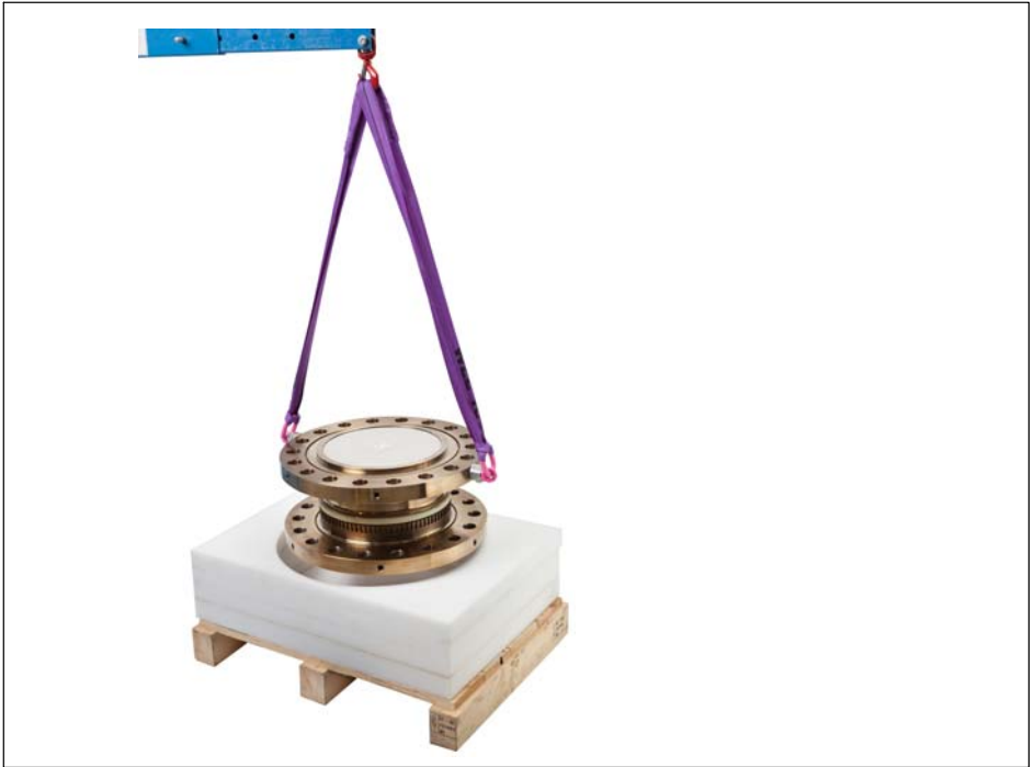
Fig. 5.2 Soulèvement du rotor de l'emballage
