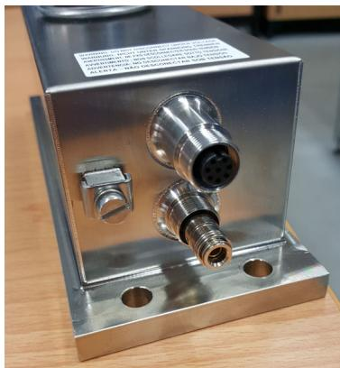
El acoplamiento rápido está cerrado sin la contrapieza. Cuando se conecta una manguera, el extremo abierto de esta debe quedar fuera de la zona 22 (es decir, fuera de la atmósfera explosiva). Se debe evitar de forma segura la penetración de polvo y humedad.
