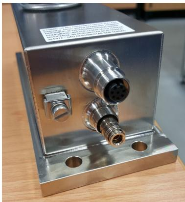
L'attacco rapido senza il riscontro è chiuso. Se viene collegato un tubo flessibile questo deve terminare con la sua estremità aperta al di fuori della zona 22 (non in atmosfera esplosiva). La penetrazione di polvere e umidità deve essere evitata in modo sicuro.
