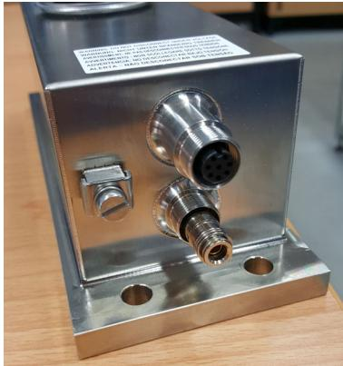
Na ausência da contrapeça, o engate rápido está fechado. Ao conectar uma mangueira, a mesma deve terminar com sua extremidade aberta fora da Zona 22 (sem atmosfera potencialmente explosiva). A penetração de poeira e umidade deve ser evitada com segurança.
