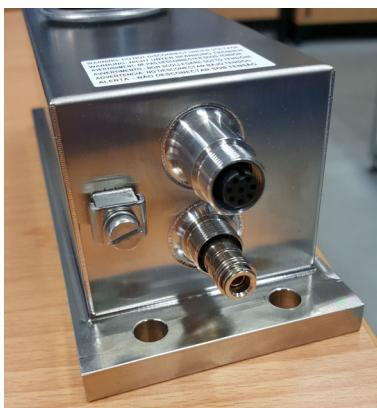
Die Schnellkupplung ist ohne das Gegenstück geschlossen. Wenn ein Schlauch angeschlossen wird, so muss dieser mit seinem Ende außerhalb der Zone 22 (keine explosionsfähige Atmosphäre) enden. Das Eindringen von Staub und Feuchtigkeit muss sicher vermieden werden.
