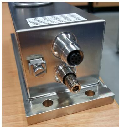
快速接头在未安装对应零件时保持关闭。如果连接了软管，则软管的开口末端必须位在 22 区 ( 没有爆炸性气体 ) 之外。必须防止粉尘和湿气渗透。
