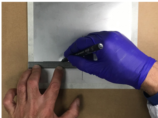
図2.7 センサの位置をマーキングします
