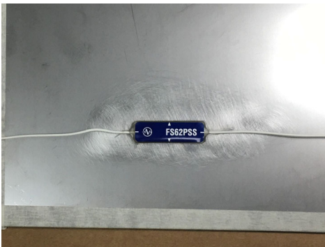
図2.14 光学式ひずみセンサの設置完了
