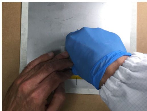
図2.20 ロゼットセンサを1分間押します
