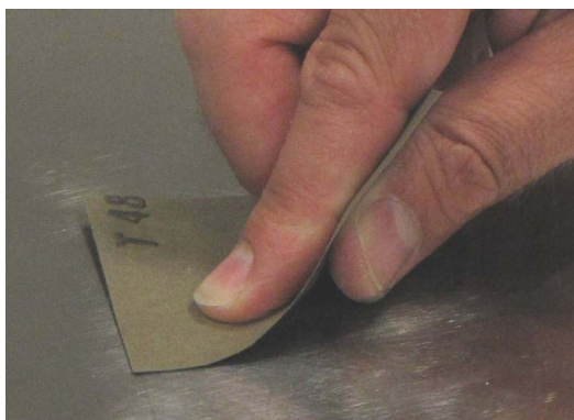
図2.4 計測対象物の表面を粗面化する
