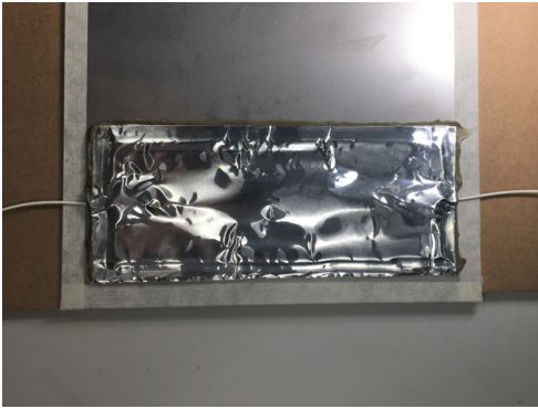
図2.31 完全に覆われた計測点
