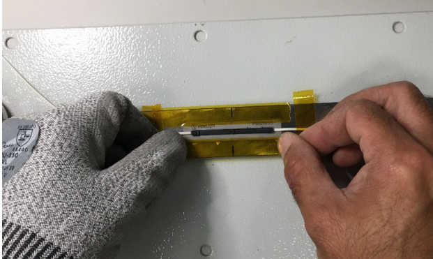
図2.11 センサを完全に固定して、溶接工程を適切に実施します。
