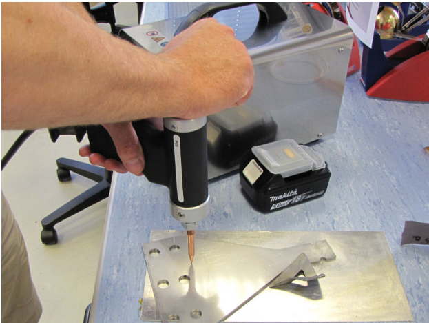
図2.15 正しい溶接位置
