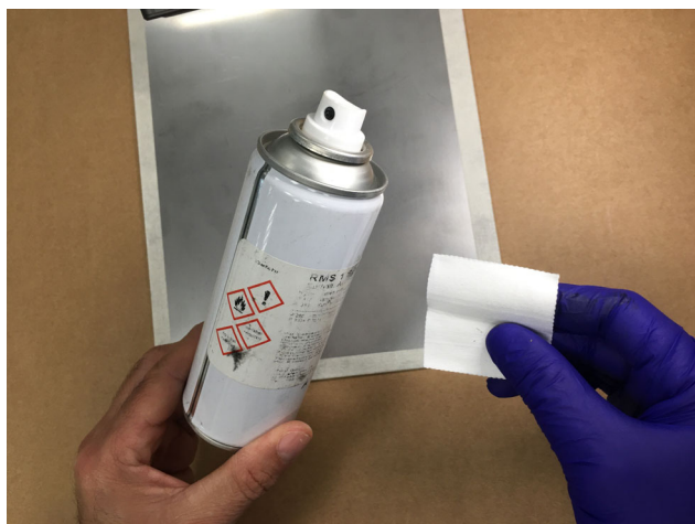
図2.5 RMS1クリーナと不織布を使用します
