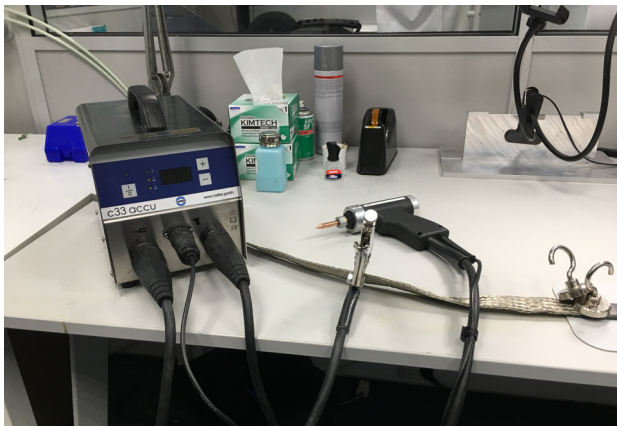
図2.12 推奨されるインパルス溶接装置
