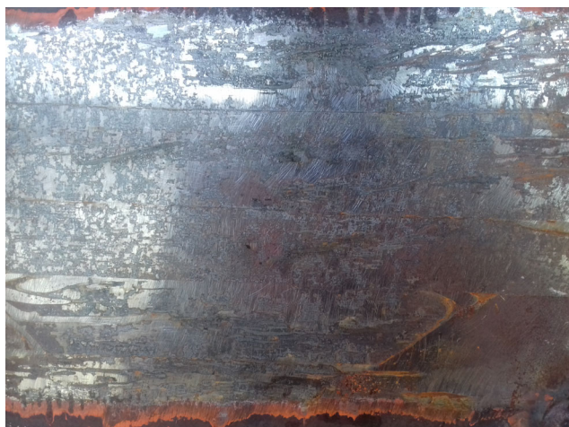
図2.2 センサの溶接には不適切なさびた表面
