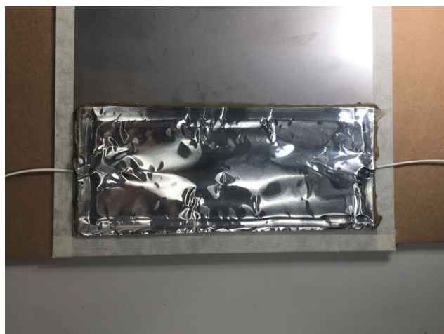
図2.31 完全に覆われた計測点
