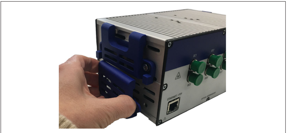
Fig. 3.14 Desmontaje de la cubierta lateral inferior
