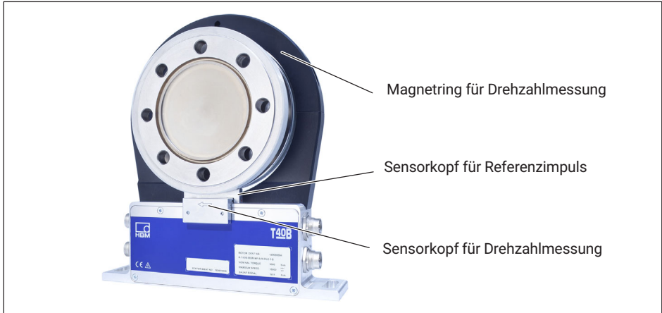
Abb. 5.8 Drehmomentaufnehmer mit Drehzahlmessung und Referenzimpuls (Beispiel T40B. Gilt sinngemäß auch für T40MS)
