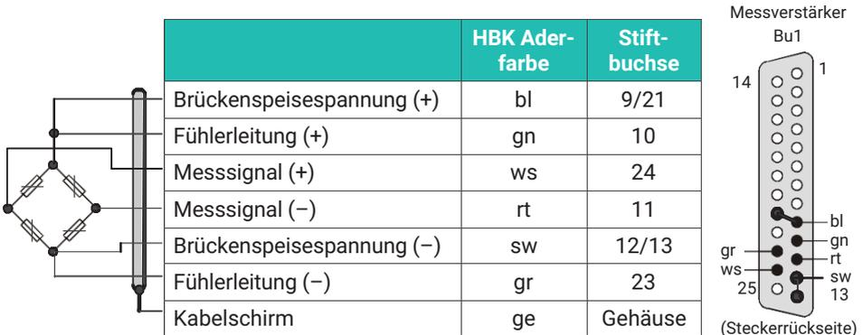
Abb. 6.1 Aufnehmeranschluss (6-Leiter) an die Messverstärkerplatine AD103C
