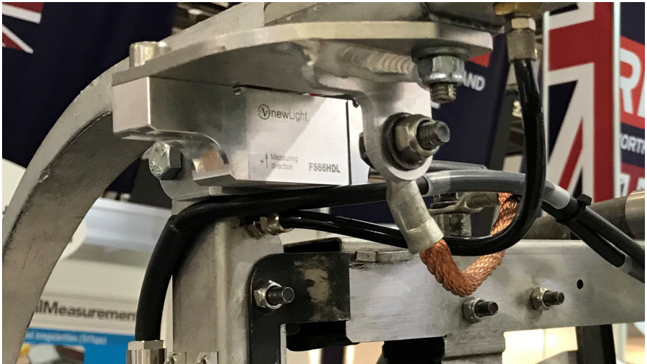
Abb. 3.5 Montierter Kraftsensor FS66HDL an einem Stromabnehmer
