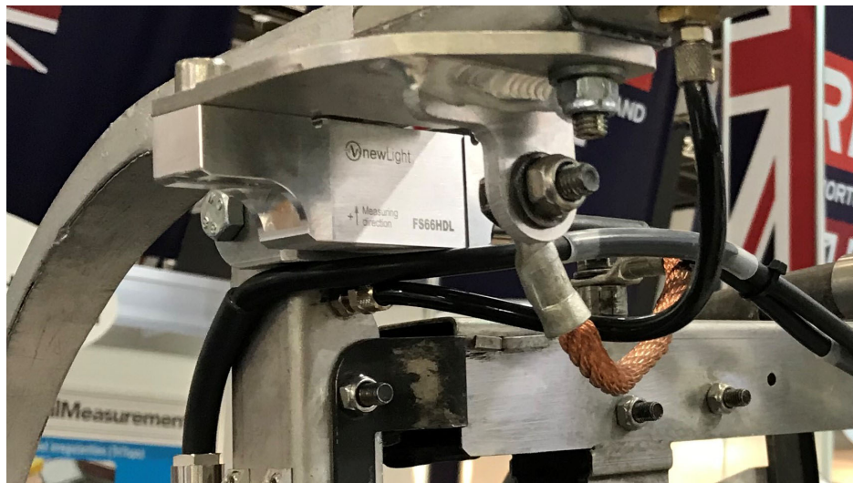
図3.5 パンタグラフにFS66HDLフォースセンサを取り付けたところ
