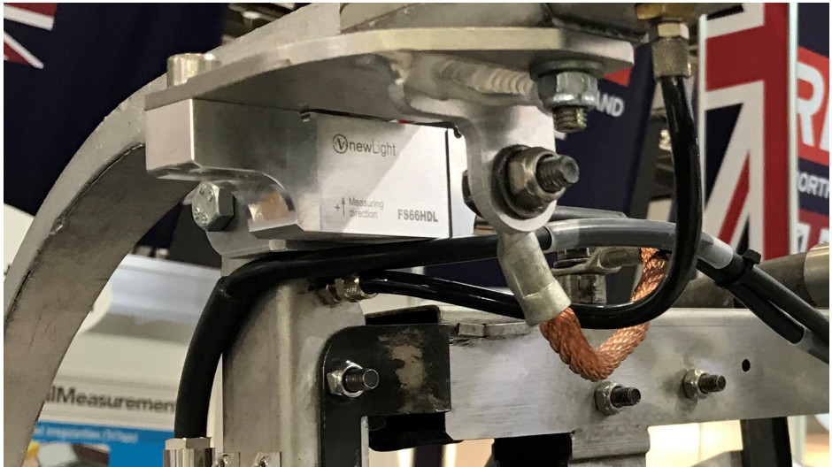
Fig. 3.5 Sensor de fuerza FS66HDL montado en un pantógrafo
