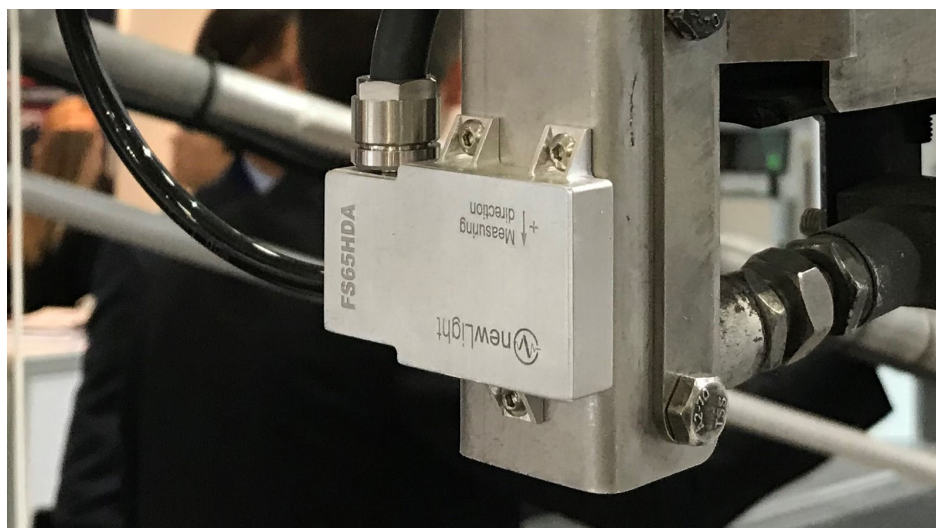
Fig. 3.7 Sensor de aceleración FS65HDA montado en un pantógrafo
