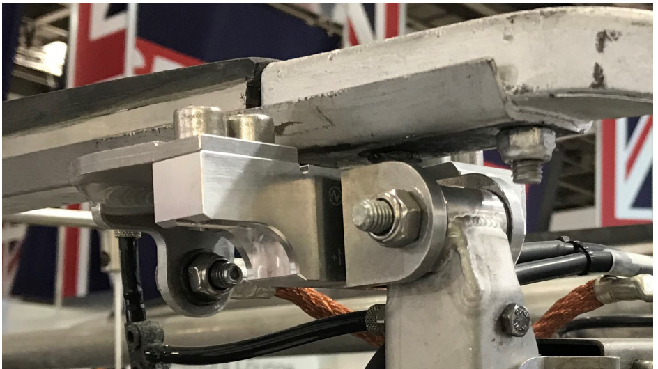
Fig. 3.4 Sensor de fuerza FS66HDL montado con abrazaderas de montaje diseñadas a medida
