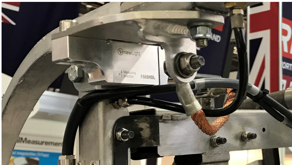
图3.5 安装在受电弓上的 FS66HDL 力传感器
