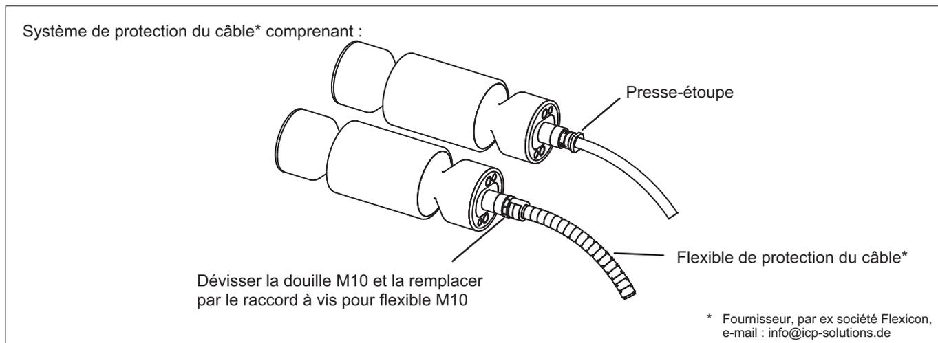
Les pesons standard atteignent le degré de protection IP68/IP69K, même sans système de protection du câble. Dans les applications où le câble PUR du peson risque d'être attaqué ou détruit par voie chimique ou mécanique, il est possible de protéger le câble en supplément avec des systèmes de protection de câble courants.
