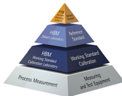
Figure 44 : Processus d'étalonnage de HBM
