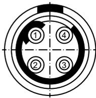
Figura 16: Vista de soldadura de conector de cable
