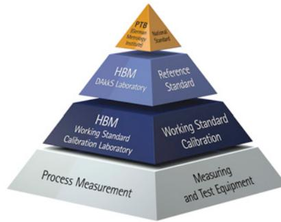
**Figura 45:**Proceso de calibración de HBM
