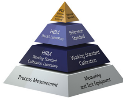
Figure 1.8 : Processus d'étalonnage de HBM
