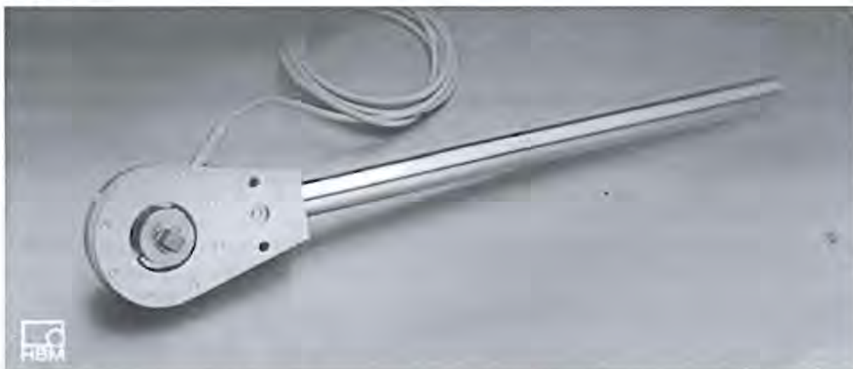
Рисунок 1. Общий вид измерителя крутящего момента силы переносного TTS
