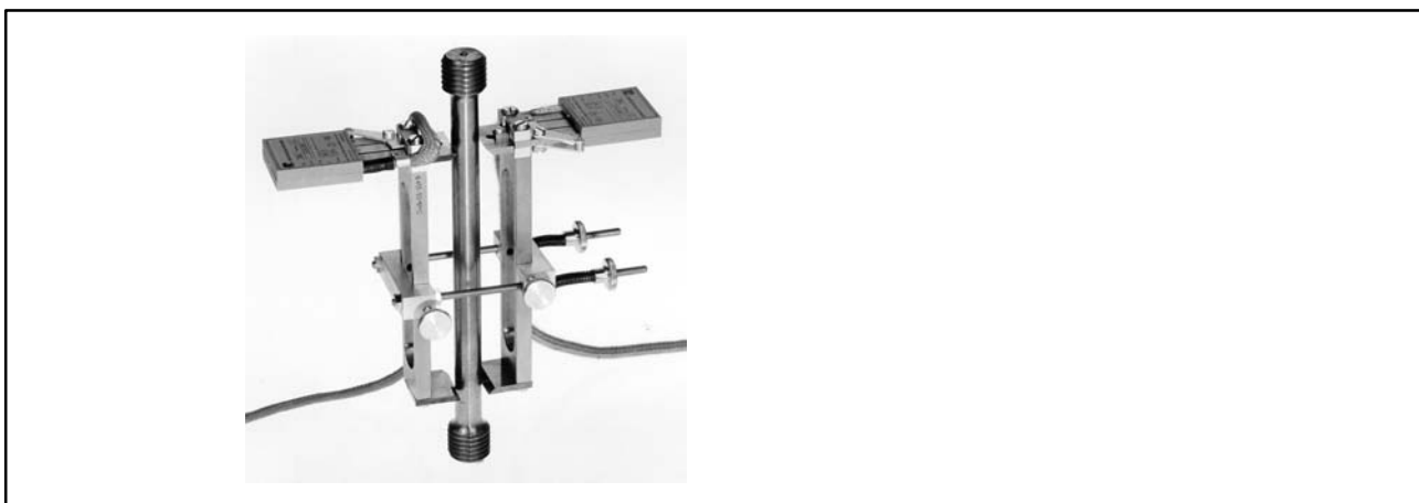
Fig. 3.2: Due estensometri per provini montati contrapposti DD1 ZA
