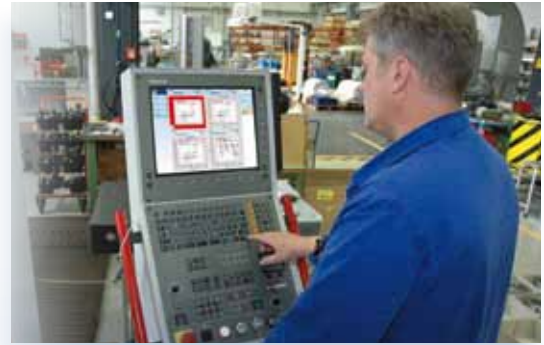
Prozesskontrolle und Visualisierung direkt an der Maschinensteuerung
