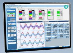
Perception ePower 软件只需点几下鼠标即可实现功率分析仪的操作,其集成了示波器、功率分析仪及录波仪的功能,能够使用预定义的和用户自定义的公式进行实时分析,更能利用存储的原始数据进行后处理以进行进一步的验证和分析,同时也可将数据导入到如 Matlab、LabVIEW 等软件进行分析。此外,分屏显示功能支持将所有的信息实时显示在多个显示器上。
