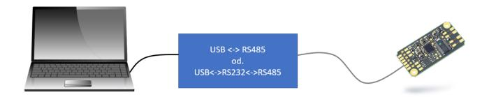
Anschließend kann die Software "PanelX" von HBM verwendet werden, um die Aufnehmerelektronik zu konfigurieren.
