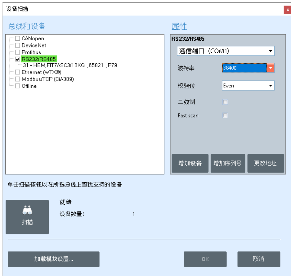
Fig. 3.5 扫描窗口，以及查找到的传感器电子设备。
